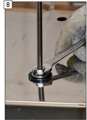
8 Jetzt mit Mutter M12 aus Edelstahl (D) kraftschlüssig festziehen.
