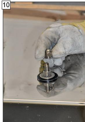
10 Hutmutter aus Edelstahl (E) montieren.
